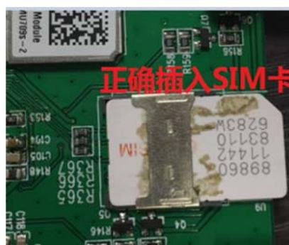
解决方法: 断电后插上 SIM 卡。注意查入 SIM 卡时, 要将 SIM 卡顶针全部压在 SIM 卡下, 然后再插入, 请勿将 SIM 卡顶针插断
