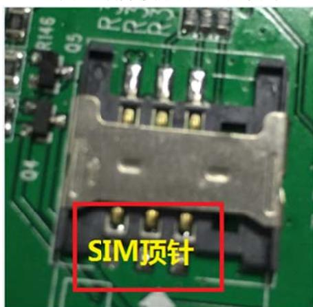
解决方法: 更换主控板或维修将SIM卡座针脚挑高。
